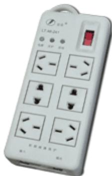
依据 IEC 标准设计，应用于设备端作为电源第三级保护。此级电涌保护器采用共模、差模防雷模式，插座式配置将电涌保护器与电源插板完美组合，RFI/EMI 滤波电路及级间协调电感器，可吸收无线电电磁干扰等线路浪涌，延长设备正常工作期限，降低长期运行成本。
