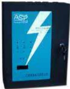
二级联动(B+C)雷击计数电源防雷箱按照 IEC 标准设计。防雷箱配备电源指示、防雷指示、缺相报警、相零反接及接地不良报警指示、雷击计数器、防雷熔断丝等，SPD 模块采用电压开关型 ASafe 模块和/或电压限制型 AM 模块（或一体化 MOV）组成。适用于小面积实现两级保护的场合或要求有低限制电压的场合。
