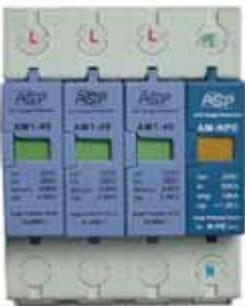
AM 系列低压配电系统电涌保护器具备大的雷电流泄放能力，每位的最大放电电流从 20-60kA，三相四模块最大放电电流大于 100kA；适用于低压配电系统的各级保护。依据不同的配电系统(TT/TN/IT)可选择多种组合方式。
